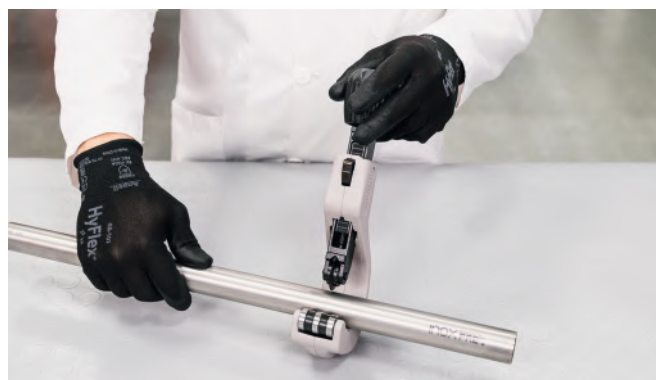
Bild 20 – Ablängen des Leitungsrohres
