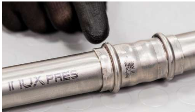
27. Ábra – Préskötés ellenőrzése
