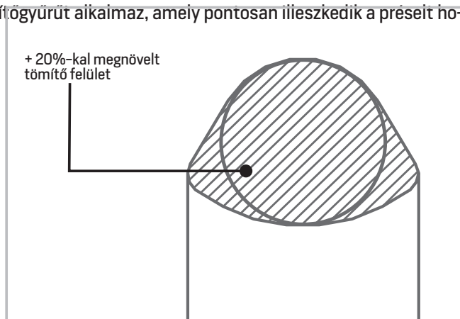
10. Ábra – Tömítőgyűrű profil
