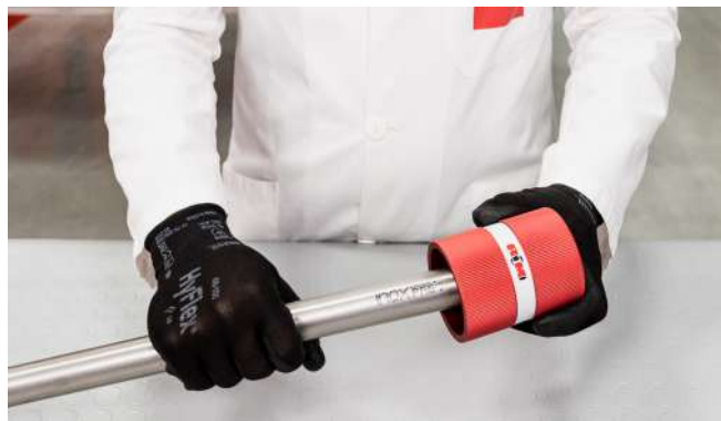
21. Ábra – Cső sorjázása
