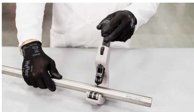
20. Ábra – Cső méretre vágása
