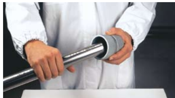
Bild 16 - Entgraten des Leitungsrohres
