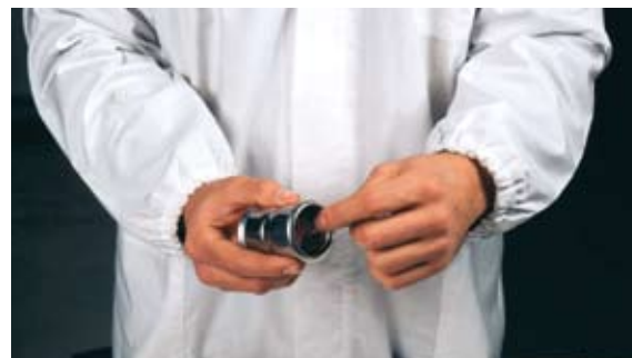
Imaginea 20 - Verificarea inelului de etanșare
