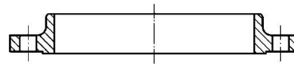
Type 12: Flangia con collare e manicotto, da saldare Hubbed slip-on flange for welding
