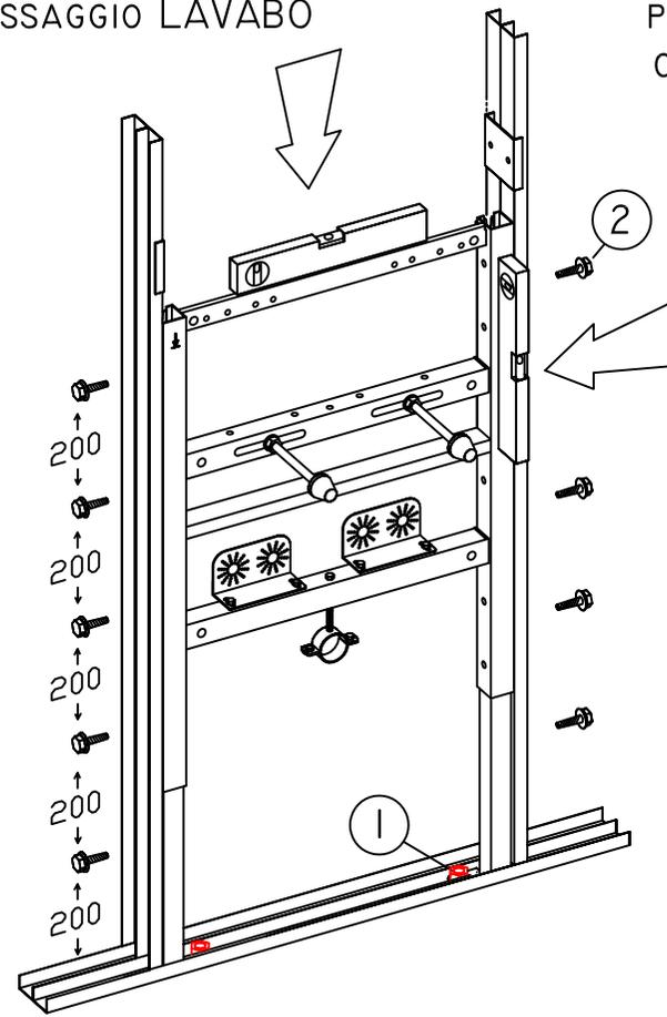
SI CONSIGLIA DI RINFORZARE I MONTANTI COME DA ESEMPIO OPPURE UTILIZZARE SISTEMI ANALOGHI IN MODO DA GARANTIRE UN FISSAGGIO A REGOLA D'ARTE.
