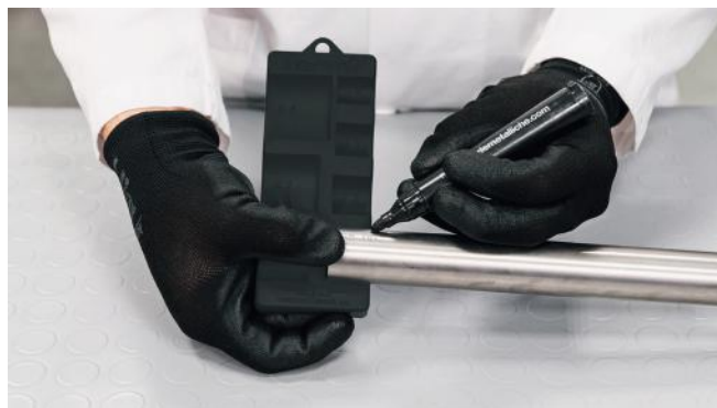
Figura 23 – Marcatura della profondità d'innesto
