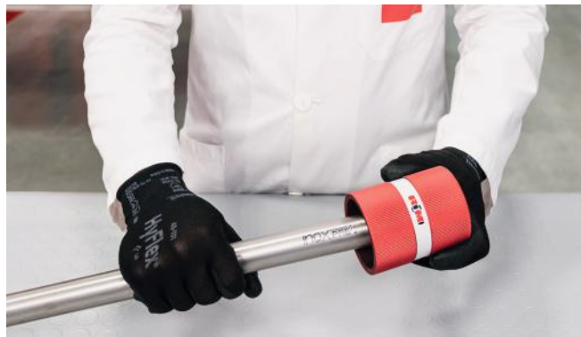
Figura 21 - Sbavatura del tubo
