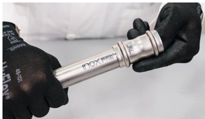
Figura 25 – Inserimento del tubo nel raccordo a pressare
