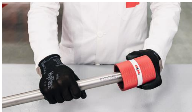
Fig. 21 – Avgradning av röret
