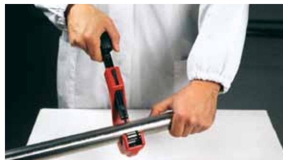
Obrázok 15 - Skracovanie potrubnej rúry
