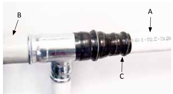
Obr. 26 - Ochrana pred externými koróznymi látkami. A. Rúra s PP opláštením B. Lakovanie so základným náterom C. Ochrana butanолоvou lepiacou páskou
