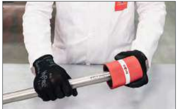
Sbavatura del tubo / Deburring the pipe
