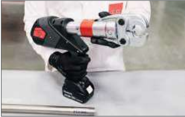
Preparazione della macchina pressatrice / Press machine preparation
