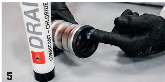
Lubrificazione zona interna guarnizione / Internal gasket lubrication
