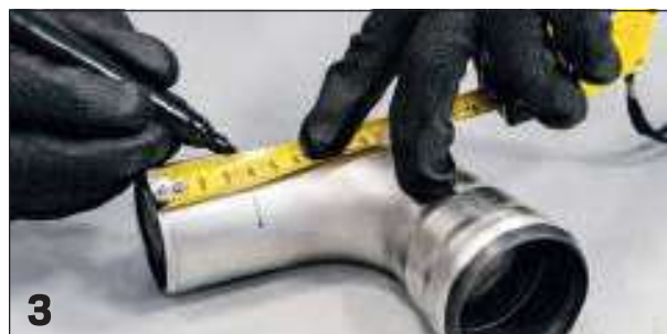
3 Marcatura quota d'innesto / Marking the insertion's depth
