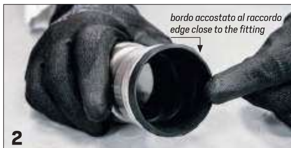
2 Verificare posizionamento guarnizione / Verify the correct gasket's position
