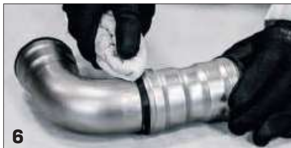
6 Pulizia di eventuale grasso residuo / Cleaning of the grease residual
