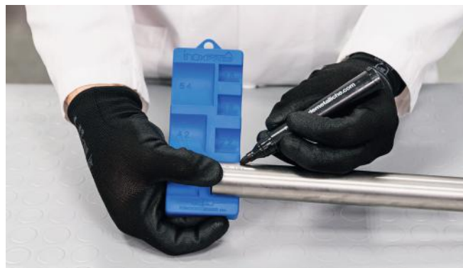
Bild 9 - Markieren der Einstecktiefe
