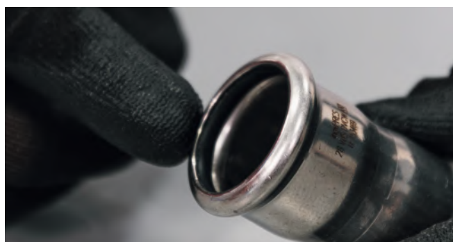
Bild 10 - Überprüfung Dichtring
