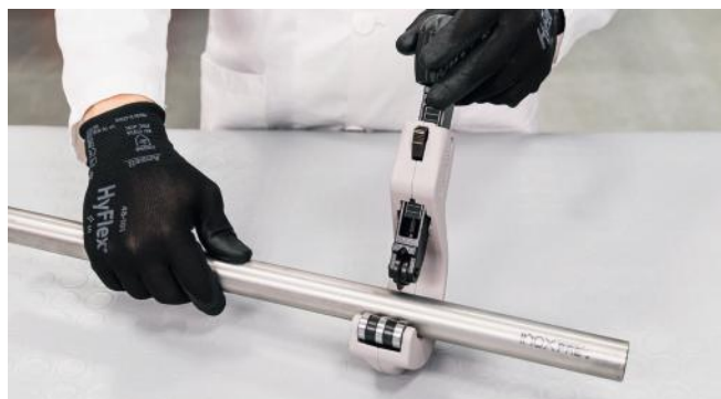
Bild 6 – Ablängen des Leitungsrohres
