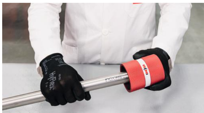
Bild 7 – Entgraten des Leitungsrohres
