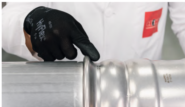
36. ábra – A túlméretes préselés szemrevételezése
