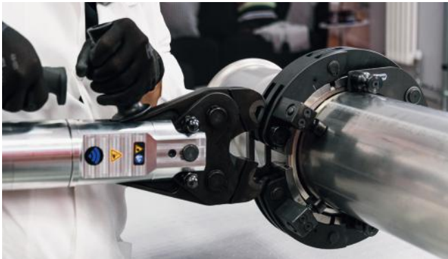
34. ábra - Préslánc összeszerelés 1. Fázis
