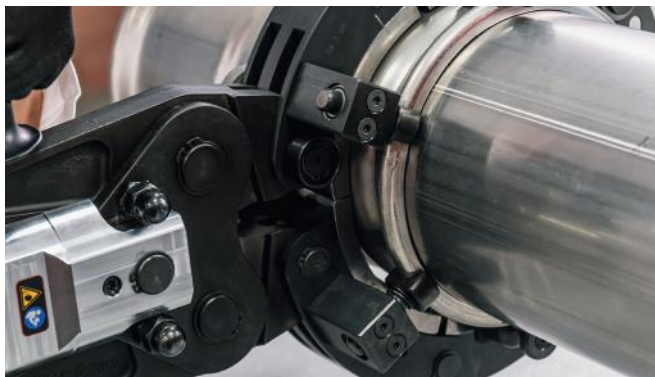
35. ábra – Prés összeszerelés 2. fázis
