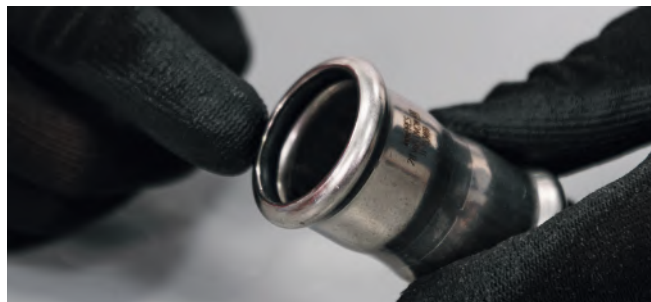
30.ábra – A tömítőgyűrű ellenőrzése
