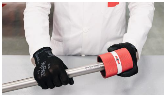
26.ábra – A csövek lesorjázása.
