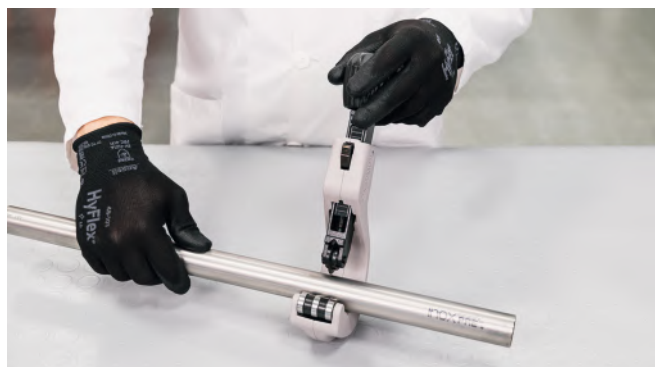
25.ábra – A csövek méretre vágása.
