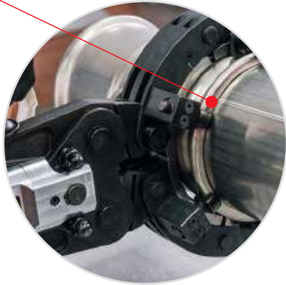
Guide sopra la sede di contenimento dell'o-ring Guides over the o-ring groove
