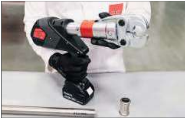
Preparazione della macchina pressatrice / Press machine preparation
