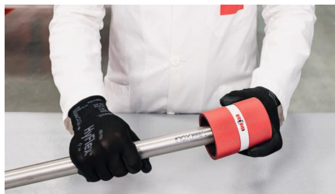
Figura 27 - Sbavatura del tubo
