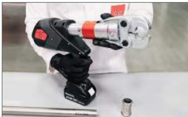
Preparazione della macchina pressatrice / Press machine preparation
