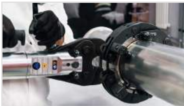
Assemblaggio pressatura n°1 / Press assembly phase 1
