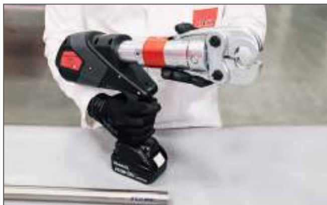
Preparazione della macchina pressatrice / Press machine preparation
