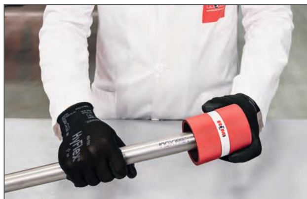
Sbavatura del tubo / Deburring the pipe
