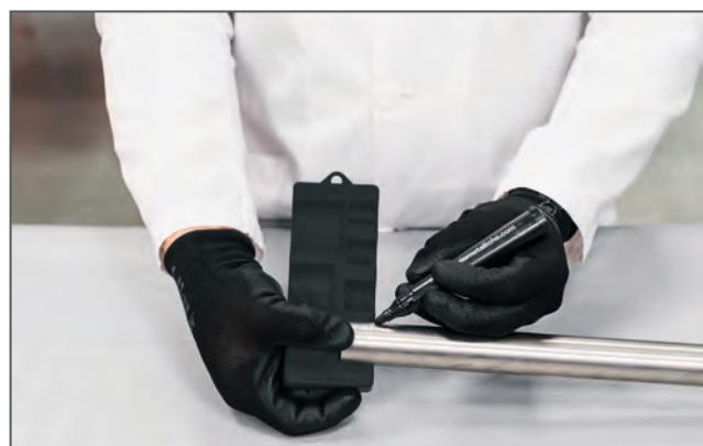
Marcatura della profondità d'innesto / Marking the insertion depth
