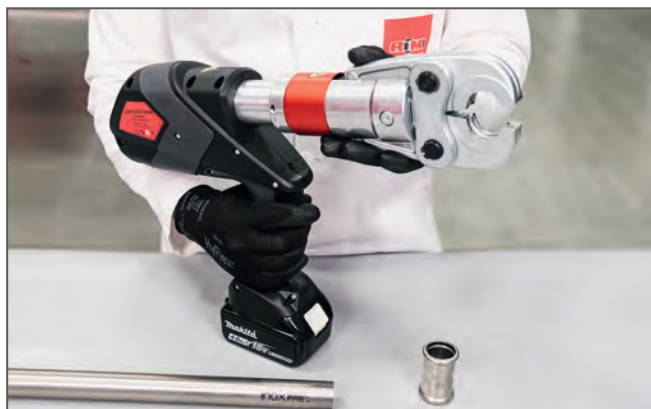
Preparazione della macchina pressatrice / Press machine preparation
