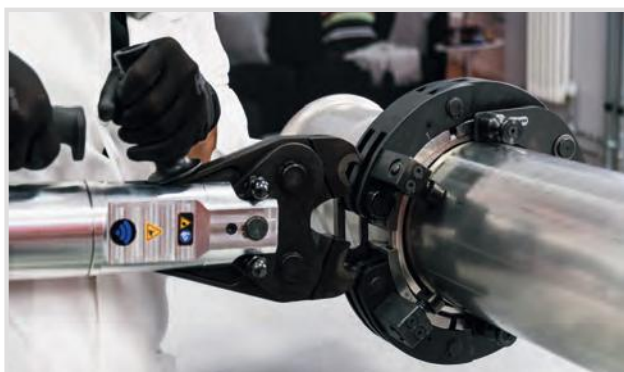
Assemblaggio pressatura n°1 / Press assembly phase 1
