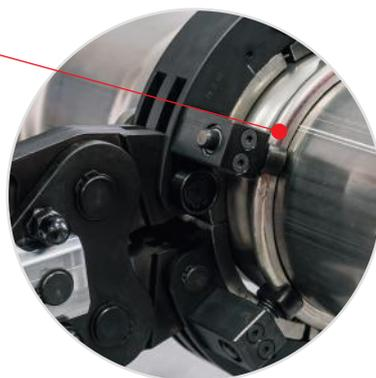
Après avoir appuyé, la connexion doit être vérifiée pour s'assurer que le travail a été effectué correctement et que la profondeur d'insertion du tube est correcte.
