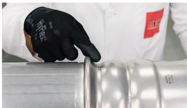
**Figure 36** - Inspection visuelle du sertissage Oversize
