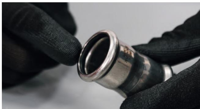
Image 30 – Vérification du joint d'étanchéité
