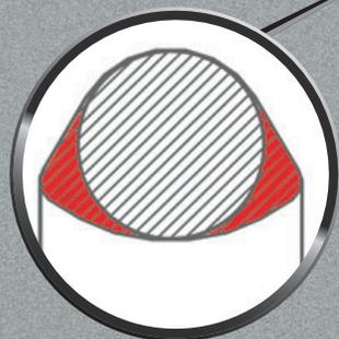
Joint EPDM noir avec **20% de surface** en plus qu'un joint standard
